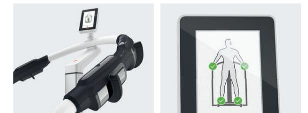
強化ガラス製の測定台に埋め込まれたLEDの足型は立ち位置を正確に教えてくれます。手足がきちんと電極と接触しているか、測定開始可能かを瞬時に本体ディスプレイに表示します。
