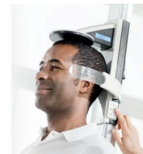
フランクフルト平面を考慮したアイラインポジションナーが、測定時の患者の正しい頭位置を示します
